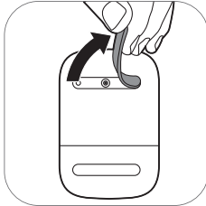
1. Tháo nút cao su ra khỏi đáy của bộ phận động cơ.
