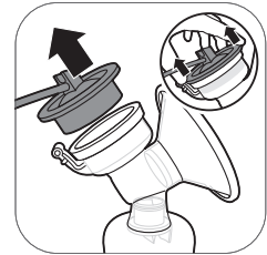
3. ถอดท่อยางซิลิโคนและฝาออกจากชุดเครื่องปั๊มน้ำนม
